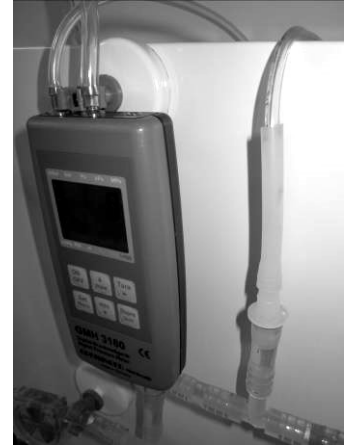
Abb. 5: Das Monometer kann mit dem mitgelieferten Magnethalter an der Metalltafel befestigt werden. Dieser wird dazu zwischen die Anschlüsse des Messgeräts gedrückt.
