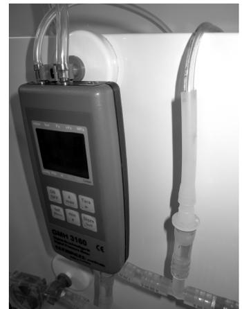
Abb. 9: Das Monometer kann mit dem mitgelieferten Magnethalter an der Metalltafel befestigt werden. Dieser wird dazu zwischen die Anschlüsse des Messgeräts gedrückt.
