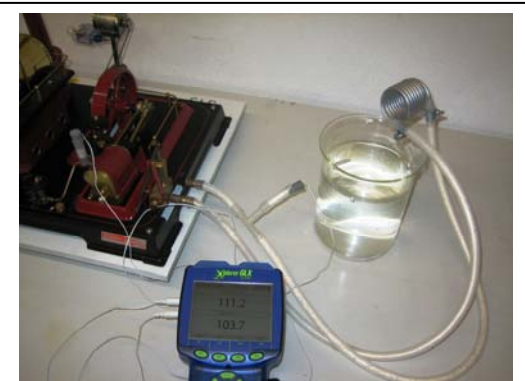
Temperaturmessung an Ein- und Ausgang der Dampfmaschine
