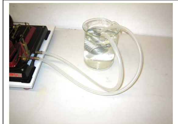
Zusammengedrückte Anschlusschläuche beim Kondensatorbetrieb
