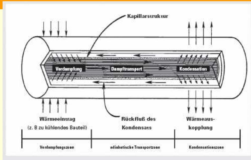
Eine Heatpipe oder ein Wärmerohr ist ein Bauteil, mit dem Wärme sehr effizient von einem Ort zu einem anderen transportiert werden kann. Es kann eine um 2 bis 3 Größenordnungen (100 bis 1000 mal) höhere Wärmemenge transportieren als ein Bauteil gleicher geometrischer Abmessungen aus massivem Kupfer.
