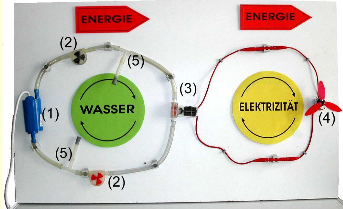
Der innere Zusammenhang von Wasserstrom und elektrischem Strom wird äußerlich sichtbar verbildlicht.
