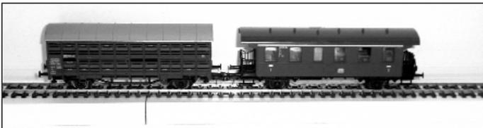
Abb. 19: Der bewegte Eisenbahnwagen kuppelt ein, der Impuls verteilt sich auf beide Wagen.
