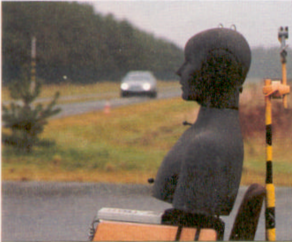
Geräuschmessung der Reifen mittels Kunstkopfmikrofon ...
